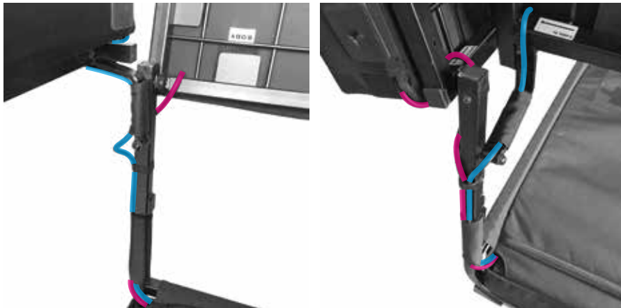
Abbildung 21: Kabelführung von HEAD und BODY an der linken Seite
